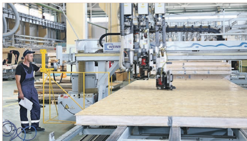
В цеху деревянного домостроения происходит сборка панелей.
